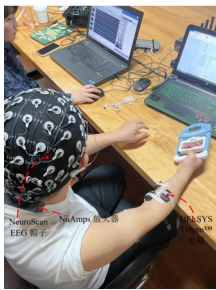
(a) EEG 和 sEMG 同步采集实验图
