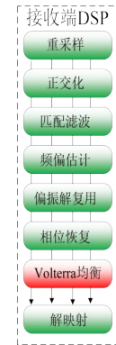
图4 基于传统OM2光纤的大容量模分复用传输系统接收端DSP流程
