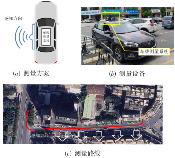
图 2 车载 ISAC 信道测量方案
